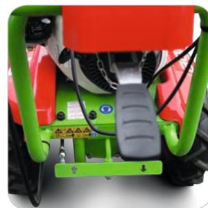
Transmission en avant et en arrière. Confortablement commutable par bascule à pied
