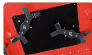
Plateau de coupe renforcé avec des robustes couteaux pendulaires
