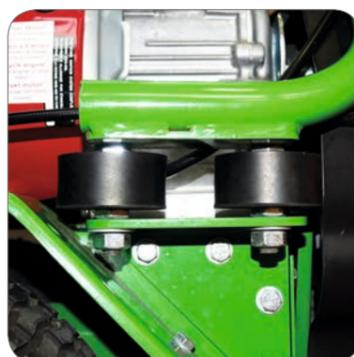
Pour plus de confort guidon monté sur silentbloks
