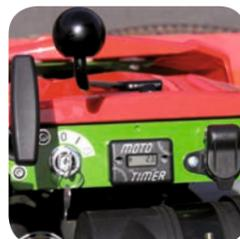
Tableau de bord utile avec compteur horaire, compteurs, serrure de contact et prise 12 V
