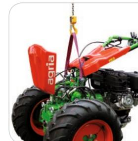
Points d'ancrage pour faciliter le chargement et le transport
