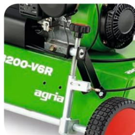
Le système de relevage rapide permet un transport facile sans incidence sur le réglage fin
