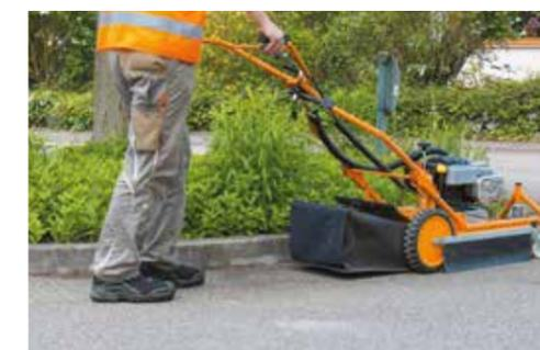
Un nettoyage parfait et sans produits chimiques. La force centrifuge régule la pression des brosses automatiquement (AS 50 WeedHex).
