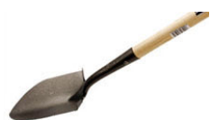
Pelle pointue plantation 15cm forgée en acier, à douille longue vernis transparent et marche-pied manche en frêne 105 cm
